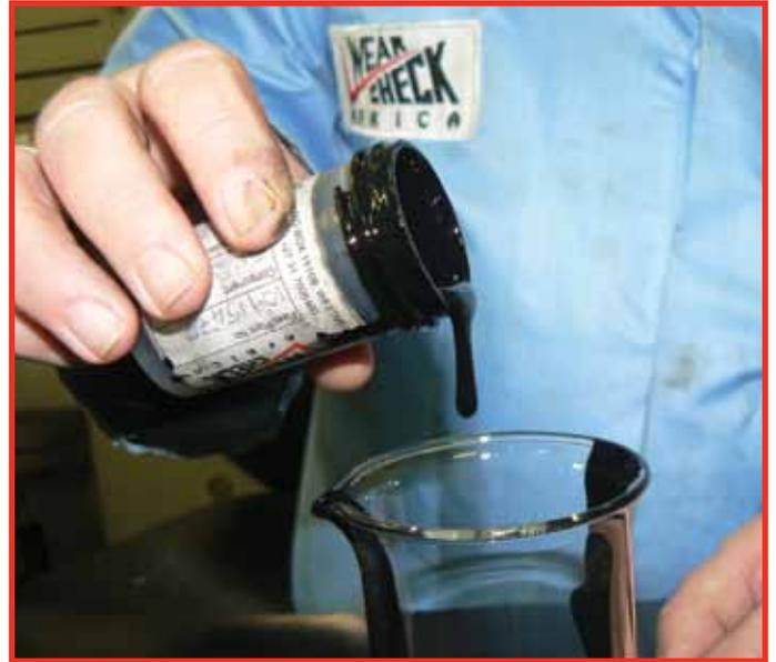
Uma amostra de óleo do motor com uma viscosidade muito elevada devida ao superaquecimento
