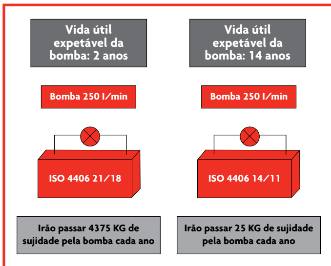
O efeito do óleo sujo na vida útil de um sistema hidráulico
