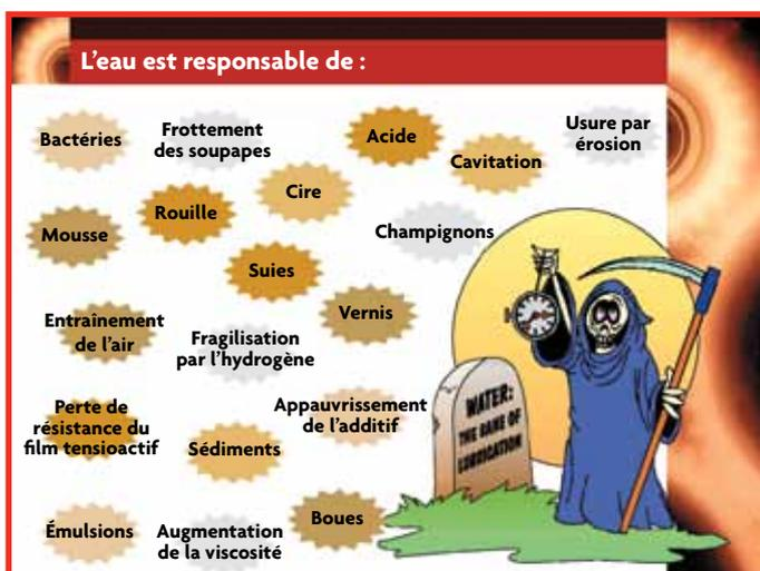
L'eau peut pénétrer de diverses manières dans un système de lubrification, par contamination lors d'un appoint ou au cours des interventions de maintenance normales.
