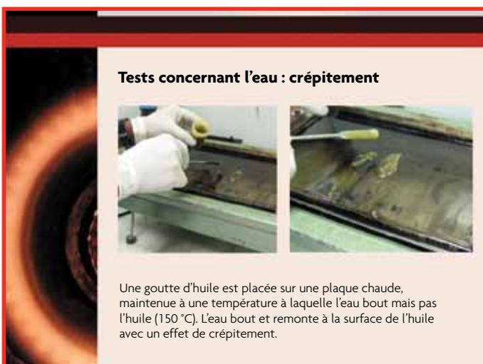
Si un échantillon est positif aux tests de dépistage, une détermination précise de la quantité d'eau peut être effectuée.
